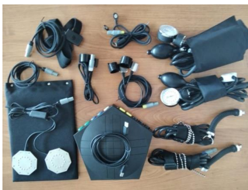
Рисунок 10. Одиннадцатиканальный казахстанский профессиональный компьютерный полиграф «AQIQAT»
