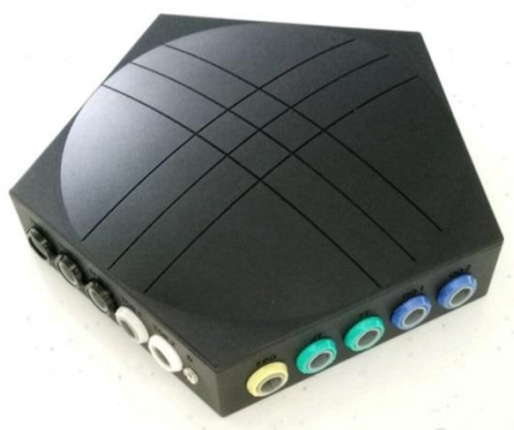
Рисунок 6. Сенсорный блок полиграфа «AQIQAT»
