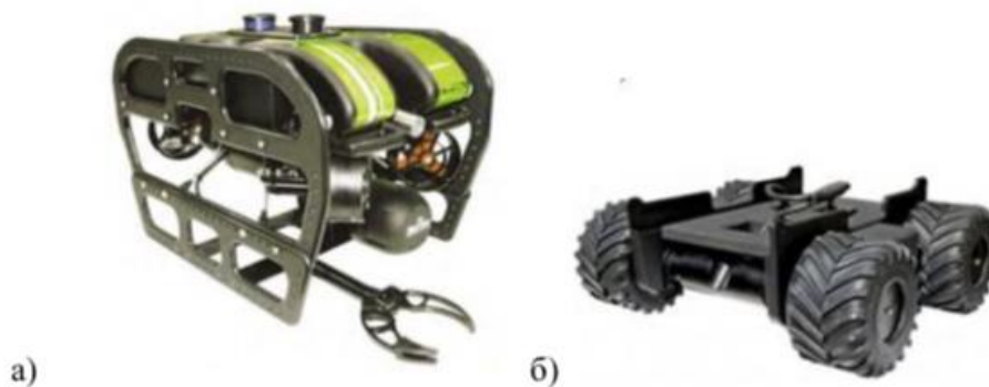
Рисунок 6. Подводный аппарат «Обзор Про 950» (а) и его прижимная колёсная рама (б)
