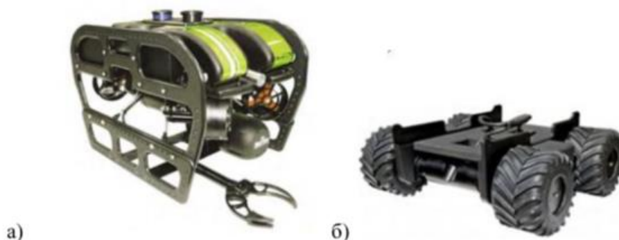
Рисунок 6. Подводный аппарат «Обзор Про 950» (а) и его прижимная колесная рама (б)
